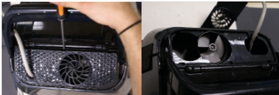
7.1. Gebruik een platte schroevendraaier om het beschermende rooster te verwijderen.
